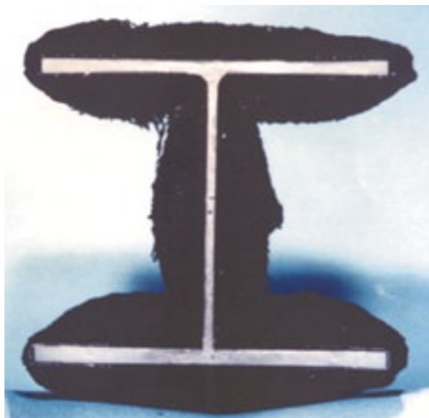
Рис. 1. Огнезащитное покрытие, вспученное под действием высокой температуры
