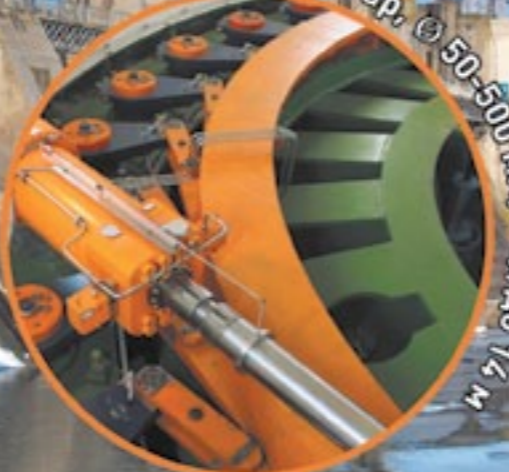
Крупные гидроцилиндры на 250 Бар, Ø 50-500 мм, ход до 1,2 м
