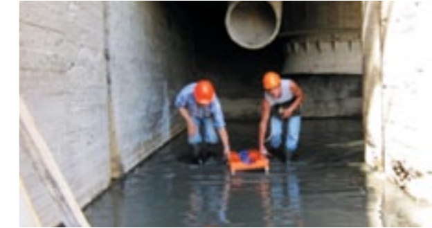
Рис. 2, 3. Деривационный и отводящий каналы. Обследование георадаром
