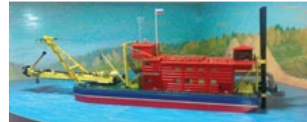
Рис. 3. Землесосный снаряд проекта 350-50Л
