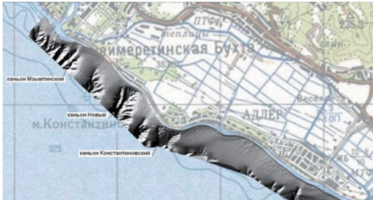
Рис. 1. План эхолотационного сканирования прибрежной зоны Имеретинской низменности
