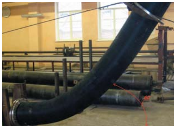
Рис. 1. Всасывающий грунтопровод диаметром 325 мм
