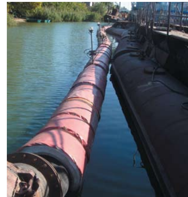
Рис. 3. Два плавучих грунтопровода диаметром 530 мм: металлический грунтопровод на понтонах и гибкий производства «Рассвет-К» позволяет перемещать гидросмесь повышенной концентрации
