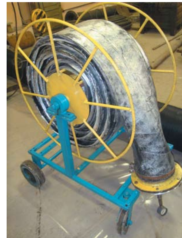
Рис. 4. Плоский грунтопровод диаметром 219 мм, длиной 30 м, намотанный на барабан
