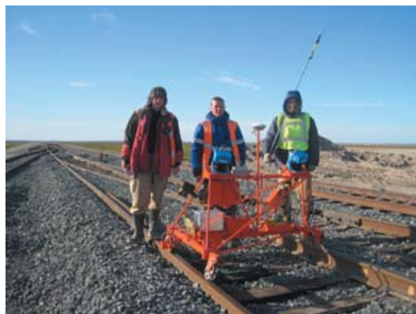
Рис. 4. Подвижный программно-аппаратный комплекс «Сканпуть»
