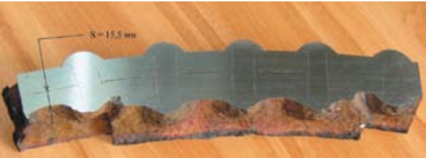
Рис. 6. Вид среза клепаного соединения по кольцу оболочки S_{ном} = 18 мм. Нижняя часть трубопровода Баксанской ГЭС. Утонение листа оболочки до S = 15,5 мм (–14%)
