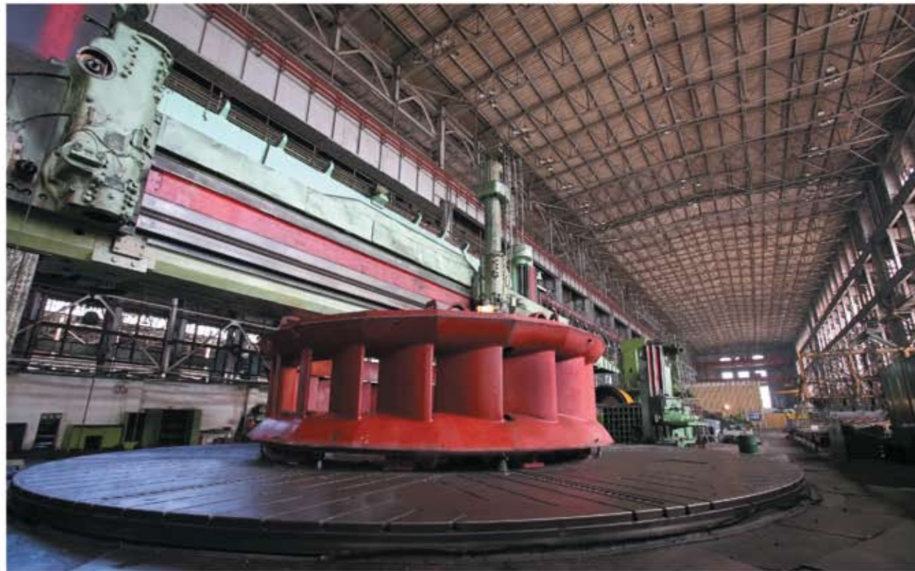
Обработка статора ГЭС на станке К 19М
