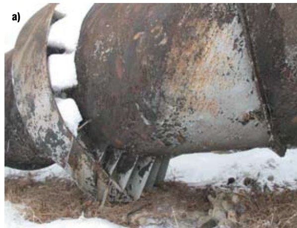
Рис. 2. Иллюстрация плохой совместимости ЛКМ, использованных для коррозионной защиты трубопроводов Баксанской ГЭС:
