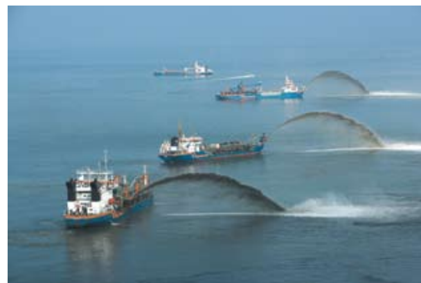
Рис. 1. Самоотвозные трюмные землесосы компании «Ван Оорд»
