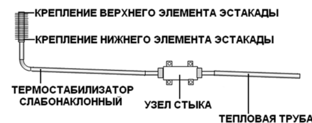
Рис. 2. Монтажное положение сборки системы
