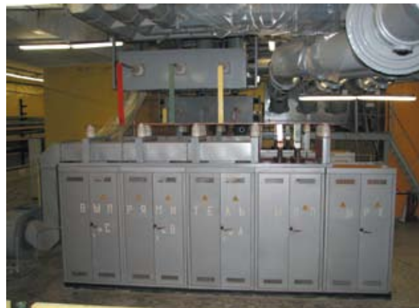
Фото 2. ПТУ-1 с преобразователем ПЧ-ТПП 15750/800
